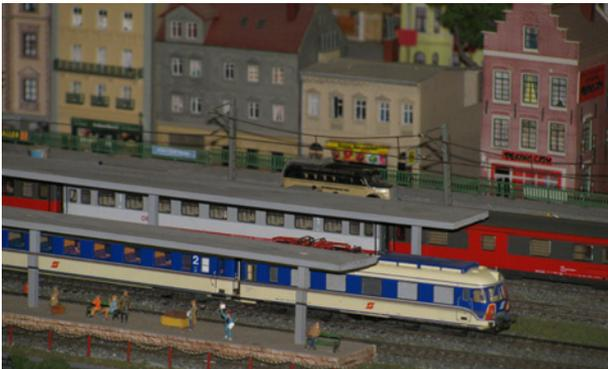
Elektrotriebwagenzug ÖBB 4010 mit Triebkopf voraus
